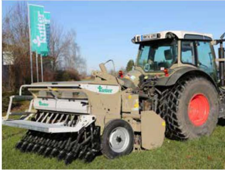
VertiRadix bringt Dünger in den unteren Wurzelraum ein und lockert gleichzeitig.
